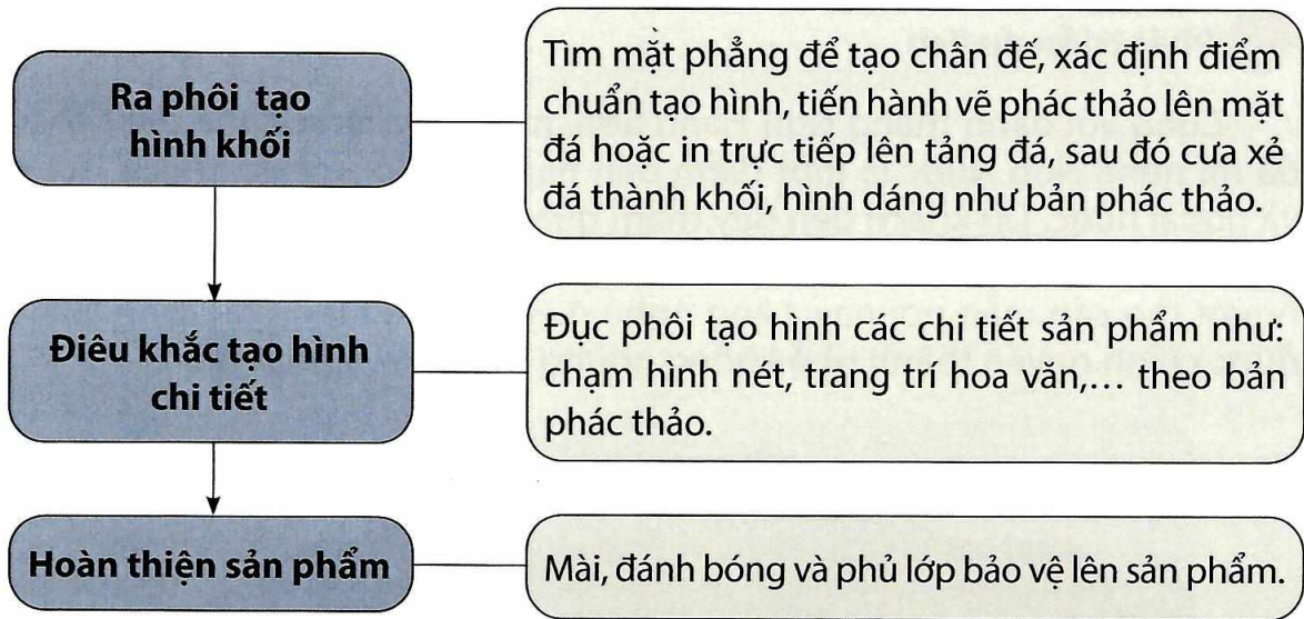
Hình 3.4. Các bước chế tác một sản phẩm đá
